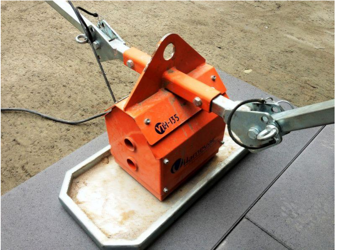
VTH-150-BL: V acuüm T il H ulp – 150 kg. hefvermogen – B lowervacuüm
