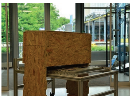
Prototype van de TEMNOS-installatie, die met behulp van AI batterijhoudende producten kan herkennen.
