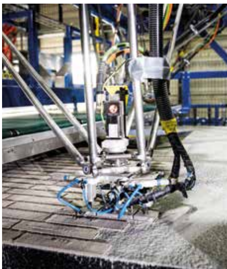
ROBOTS IN DE FABRIEK VAN RC PANELS MAKEN DE GEVEL VOOR DE PILOT IN ENSCHEDA.
