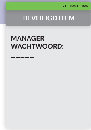
3. Voer het manager wachtwoord in (standaard ingesteld op 99999) en bevestig met groene toets OK
