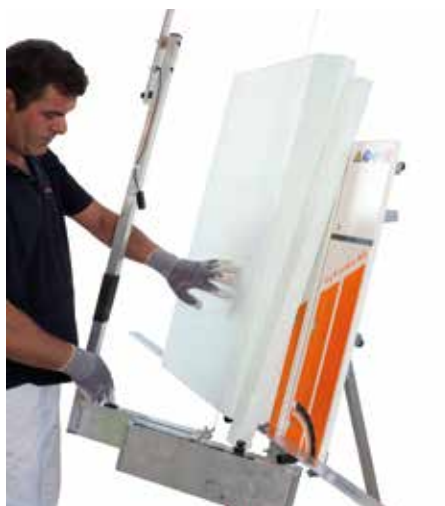
Découpe oblique à 45° du panneau isolant pour soubassement
