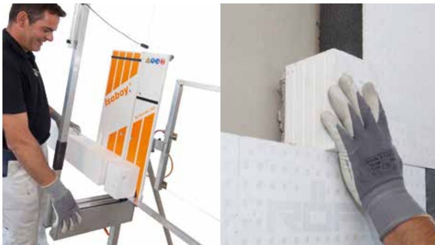
Couper RÖFIX Quick-Quader avec RÖFIX ISOBOY GD 34 et le coller au support avec un enduit de collage et lissage du système
