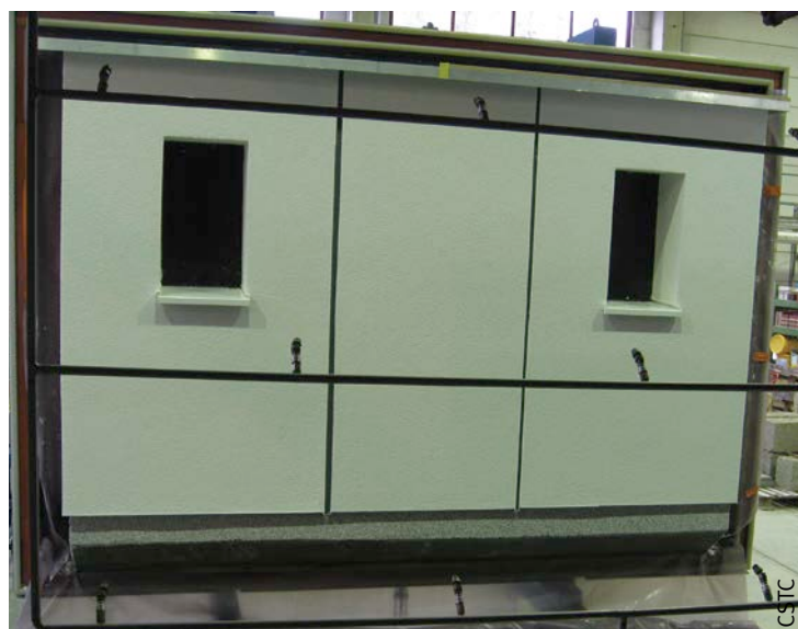
Fig. 40 Maquette 'Grand mur' qui simule une façade revêtue par des ETICS et qui est destinée à l'évaluation en laboratoire du comportement hygrothermique (ETAG 004 [E3], procédure BA-521-1 [U1], NBN B 62-400 [B5]).
