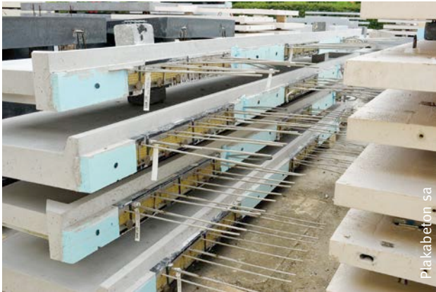
Fig. 79 Balcons préfabriqués intégrant un rupteur thermique.
