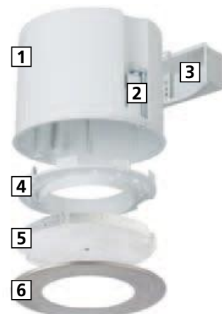
1 Behuizing | 2 FX 4 Schroefverbinding | 3 Transformatorklep | 4 Frontdeel met bajonetsluiting | 5 Mineraalvezel-frontdeel | 6 Sierplaatje Ø 125 mm
