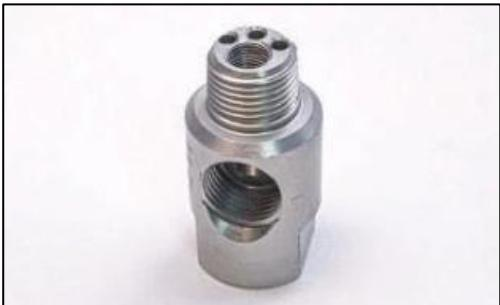
Teilt einen 1/2" NPT-Füllanschluss in zwei unabhängige Anschlüsse zum Befüllen und Entlüften. Ermöglicht gleichzeitiges Befüllen und Belüften ohne Kontamination. Der 1/8"-Anschluss kann auch mit dem Säulen-Entlüftungsschlauch-Kit verbunden werden. Anschlüsse: 1/2" NPT Innengewinde-Füllanschluss; 1/2" und 1/8" NPT Innengewinde-Entlüftungsanschlüsse.
