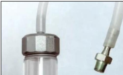
Leitet Luft von der Oberseite der Säule zurück in den Kopfraum der Maschine, erzeugt einen geschlossenen Kreislauf und nutzt einen eventuell installierten Trockenmittelentlüfter. Enthalten: Edelstahl-Schlauchtüllen an beiden Enden (1" NPT Innengewinde, 1/8" NPT Außengewinde), 6' Länge 1/4" ID LLDPE-Schlauch.
