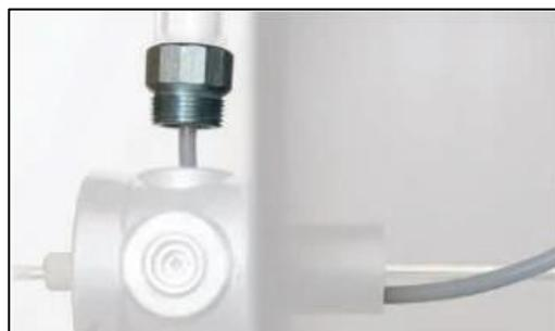
Wird verwendet, wenn die Säule auf einem Luneta Hub mit angeschlossenem Filterwagen montiert ist. Das Bypass-Kit verhindert, dass der Filterwagen Öl aus der Säule ansaugt. Enthalten: verzinkte und Edelstahlanschlüsse, 1" NPT-Außengewinde, 6' Länge 1/4" Hochtemperatur-Nylonschlauch.
