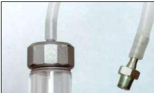
Conçu pour renvoyer l'air du haut de la colonne vers le volume libre de l'équipement, créant une boucle fermée et exploitant tout reniflard déshydratant installé. Inclus : raccords cannelés en acier inoxydable à chaque extrémité (1" NPT femelle, 1/8" NPT mâle), tube LLDPE de 6' en 1/4" ID.
