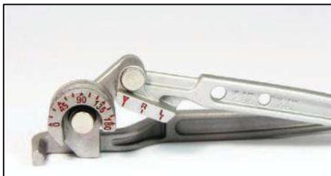
Permet de réaliser des cintrages précis des tubes pilotes du CMP ou du Hub, garantissant un positionnement correct à l'intérieur de la machine.
