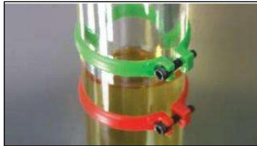
Deux bagues de niveau inviolables marquent les niveaux d'huile à l'arrêt et en fonctionnement. Fabriquées en nylon durable et fixées à l'aide d'une vis à tête creuse en acier inoxydable. Inclus : bagues en nylon rouge et verte (1 de chaque), vis en acier inoxydable, clé hexagonale.
