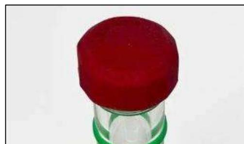
Si le reniflard de colonne est exposé à des environnements sévères — tels que des conditions extérieures, une forte poussière ou la proximité de contaminants extrêmes — le capot de colonne en silicone offre une protection robuste. Spécifications : silicone rouge résistant aux produits chimiques et aux chocs ; température de fonctionnement -55°C à +300°C.
