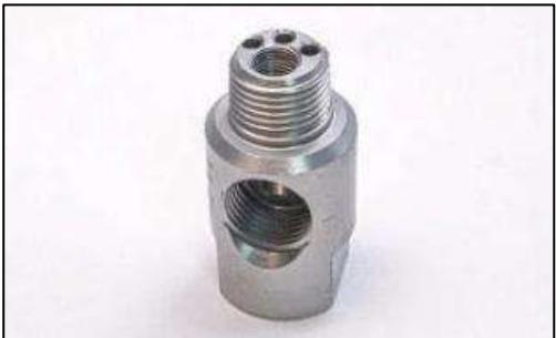
Divise un port de remplissage 1/2" NPT en deux ports indépendants pour le remplissage et la respiration. Permet un remplissage et une mise à l'air simultanés sans contamination. Le port 1/8" peut également être connecté au kit de tube de ventilation de colonne. Ports : port de remplissage femelle 1/2" NPT ; ports de respiration femelles 1/2" et 1/8" NPT.
