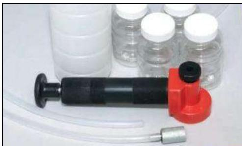
Un kit d'échantillonnage complet et prêt à l'emploi, conçu pour les systèmes à haut débit.
