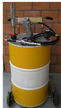
Stationäre Ausführung, montiert auf einem robusten, fahrbaren 4-Rad-Wagen. Mit Schlauch und Ölpirsche, um den Füllpunkt der Maschine direkt zu erreichen. Digitaler Verbrauchsmesser/Schlauchaufroller als Option.
