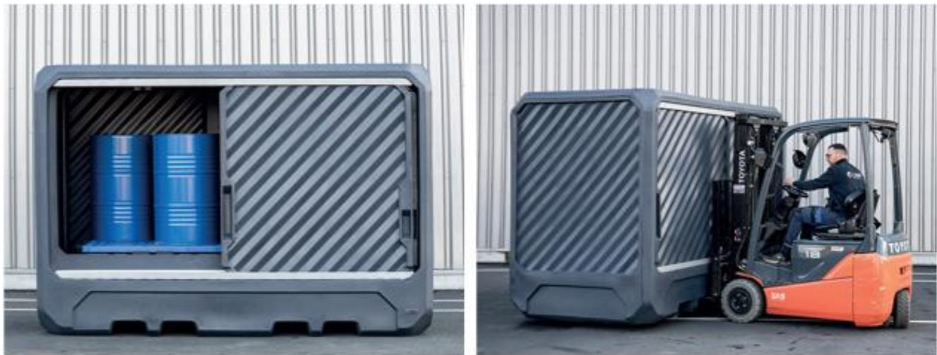
Une unité de stockage et de rétention robuste, conçue pour deux IBC de 1000 L ou huit fûts de 220 L. Fabriquée en polyéthylène haute densité (PEHD) par rotomoulage ; conforme à la réglementation européenne relative au stockage des substances dangereuses.
