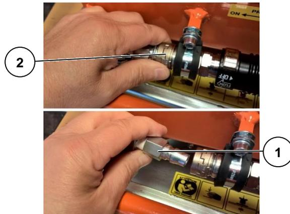
Abbildung 8: Vakuumschlauch lösen
