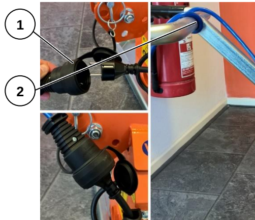
Abbildung 9: Anschließen des Netzkabels (Beispiel)
