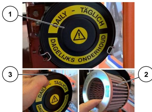
Abbildung 23: Filter wechseln
