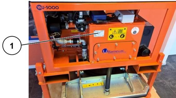
Das Typenschild (1) befindet sich auf dem Puffertank. Die folgenden Daten sind auf dem Typenschild angegeben:
