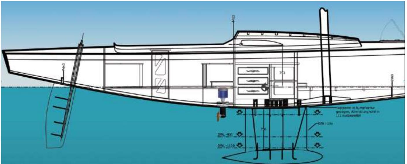
Als Sail-Drive bezeichnet man eine spezielle Antriebskonstruktion bei Motor- oder Segelyachten. Es handelt sich dabei um eine leicht einzubauende Kompaktanlage.
