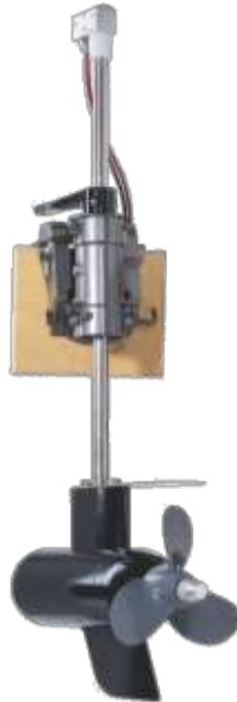
Abbildung: Außenborder für Lenkradsteuerung
